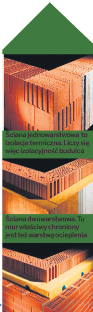
Ściany trójwarstwowe są jak dwuwarstwowe rozszerzone o dodatkowy mur osłonowy
